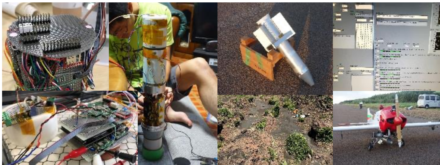
諏訪之瀬島でのペネトレーター型 観測装置の投下実験
